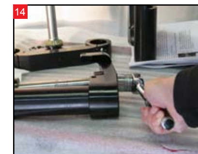
Loosen the adapter block bolt.
